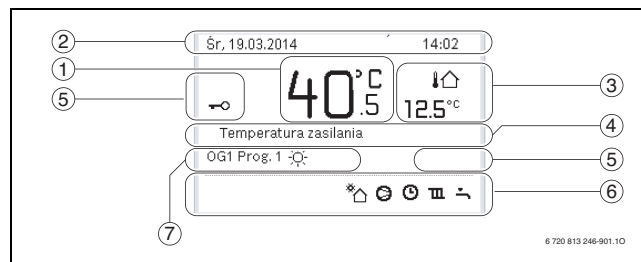
Rys. 6 Symbole na ekranie wskazania standardowego (przykładowy wyświetlacz)
