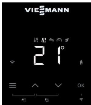
Siedmiosegmentowy wyświetlacz LED z przyciskami dotykowymi
